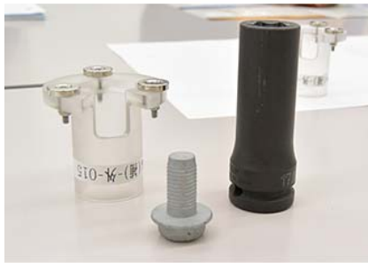
写真5) タッピングボルト案内装置治具 (写真左)
